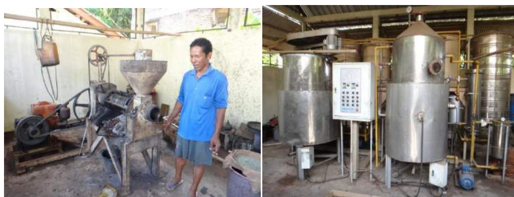
Gambar 10-4. Pengolahan biji nyamplung menjadi biokerosin pada Koperasi Jarak Lestari, Kabupaten Cilacap. ©Supian
